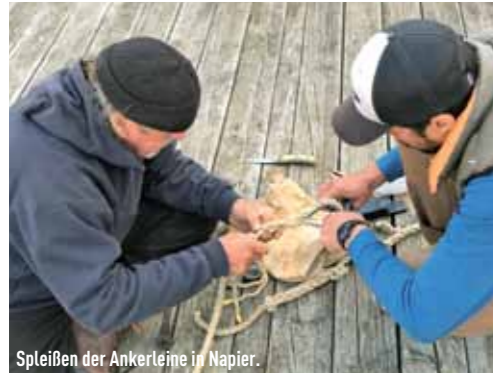
Spleißen der Ankerleine in Napier.
